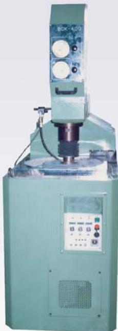
研磨圧力をエアーにより任意に設定
