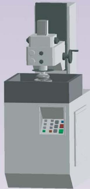
研磨圧力をエアーにより任意に設定
